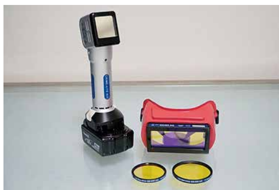
圖1：高功率445nm光源搭配495nm濾鏡
