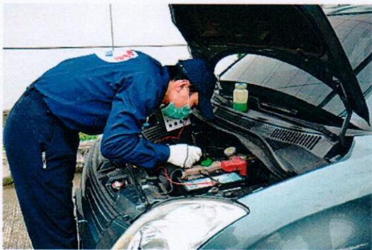
圖六、鑑識人員以化學藥劑顯現法進行引擎號碼重現工作
