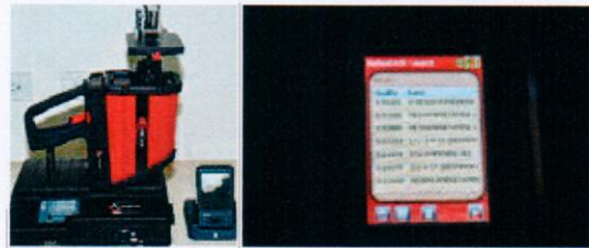
圖七、可攜式傅立葉轉換紅外線光譜分析儀(左)初步篩檢製毒工廠疑似毒品之結果
