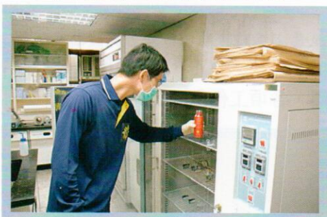
圖四、鑑識人員將證物放入煙燻箱以氰丙烯酸酯法處理
