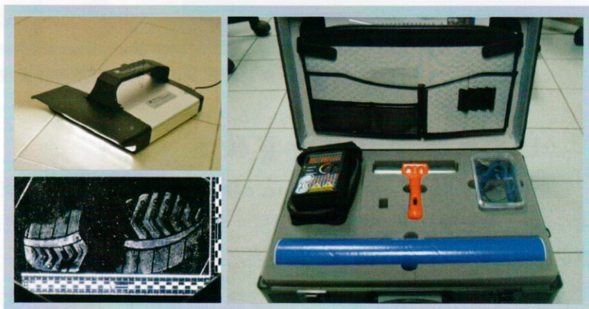
圖十五、使用靜電足跡採取器(右)顯現鞋印(左下)並以線性光源(左上)提高紋線清晰度
