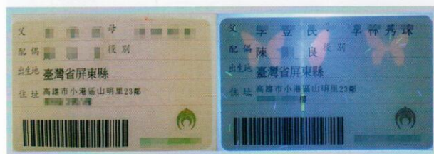
圖十、身分證背面在紫外光下有防偽螢光纖維和圖案(右)可見光下則無(左)
