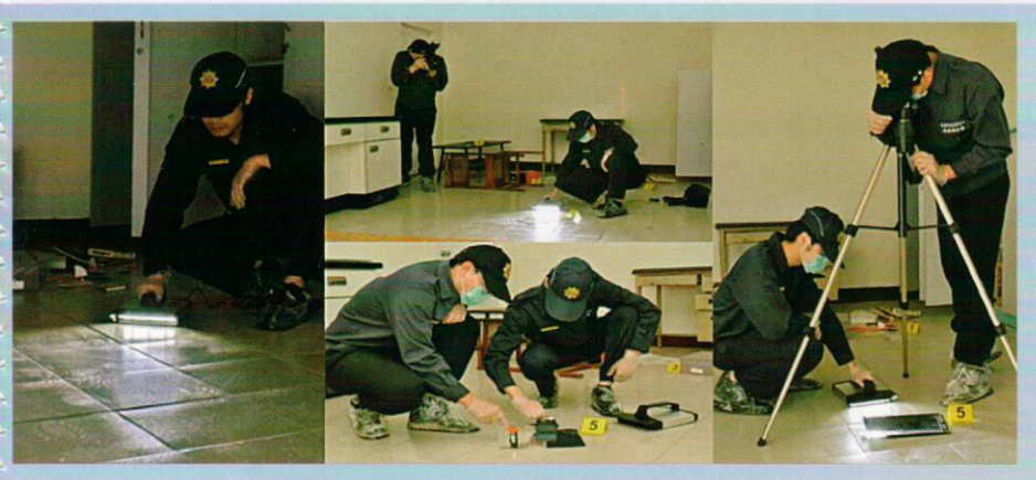
圖十六、竊盜案模擬現場 使用靜電足跡採取器及線性光源採集鞋印情形
