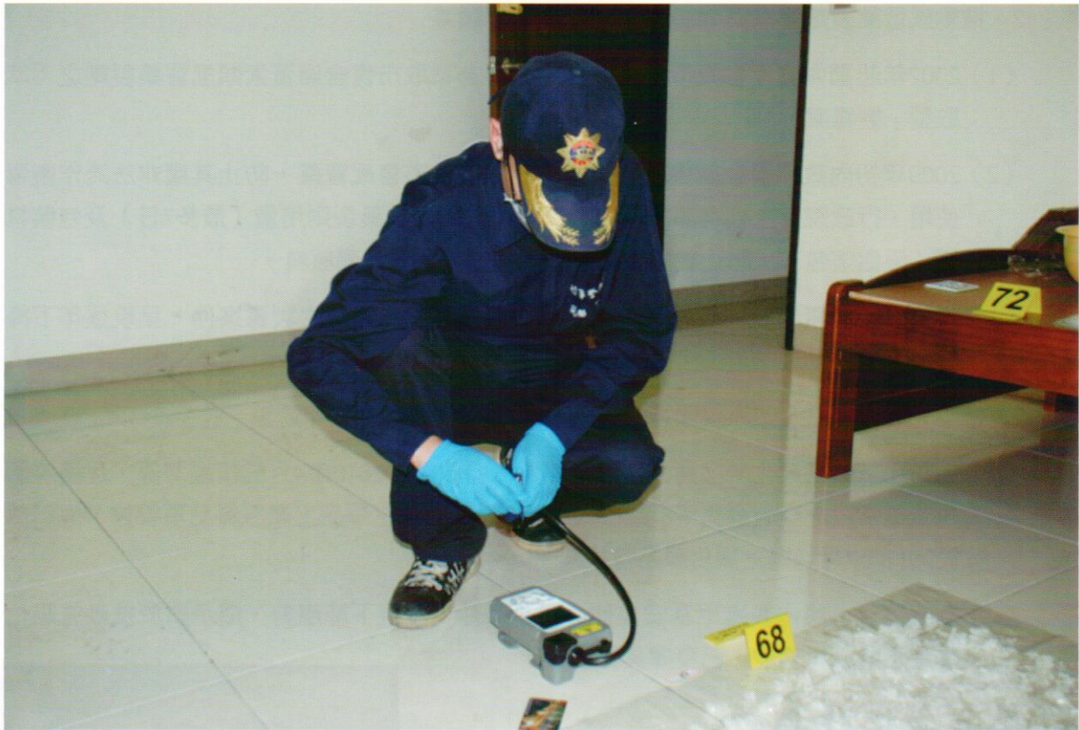
圖19.鑑識人員於製毒工廠中使用拉曼光譜儀進行檢測
