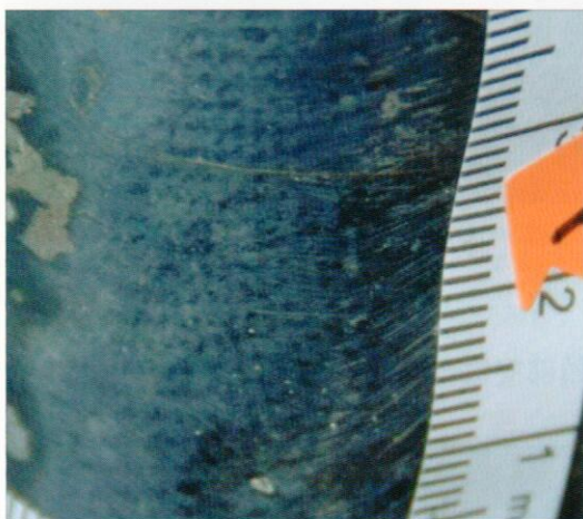
圖17、案例二重機車避震器上織物痕
