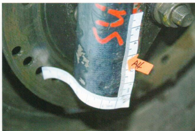
圖16、案例二重機車避震器上織物痕
