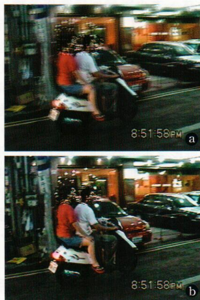
圖三 (a)不同步的影像資料 (b)抽取部分資料進行內插處理結果
