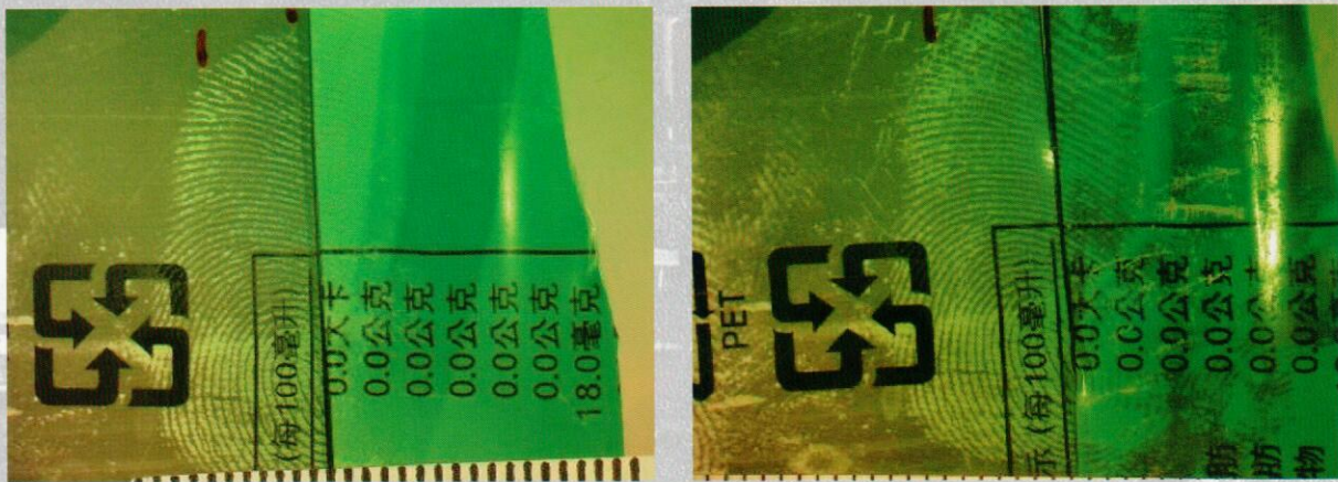
圖七 寶特瓶外包裝膜潛伏指紋 左圖以真空金屬鍍膜法顯現，右半部上圖以氰丙醯酸酯顯現，右圖續以真空金屬鍍膜法顯現
