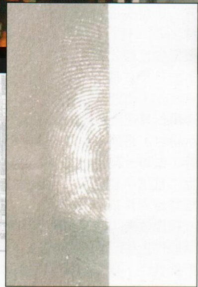
圖六 浸水紙張（右半部寧海德林法， 左半部真空金屬鍍膜法）
