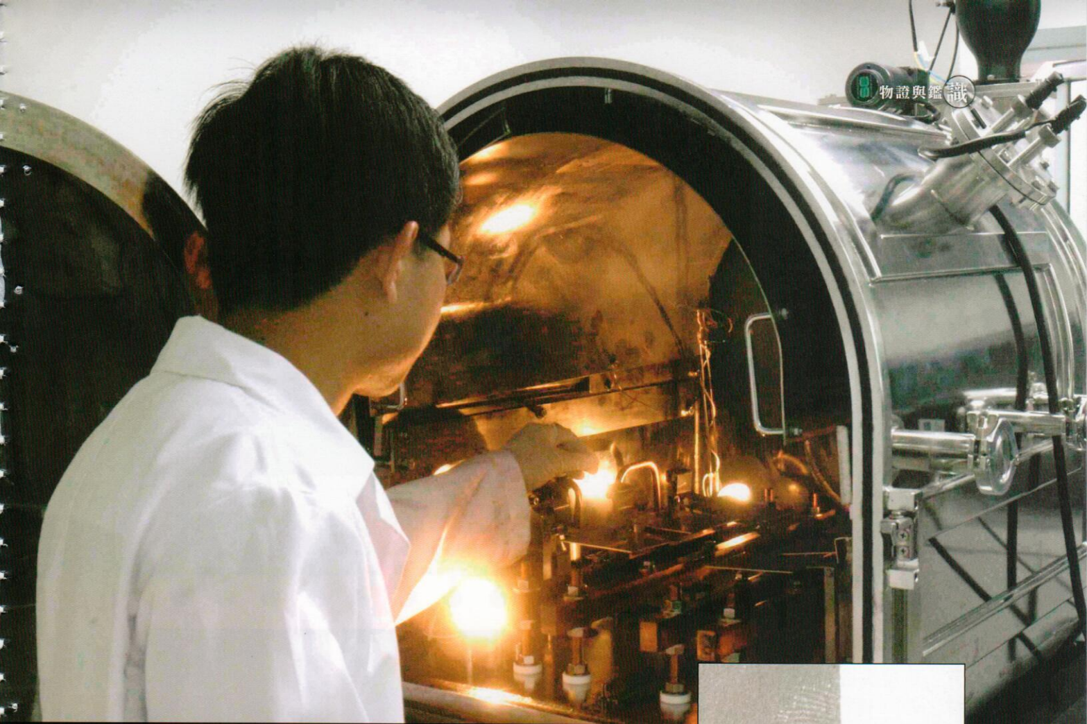
圖五 刑事局建置國內第一套真空金屬鍍膜設備
