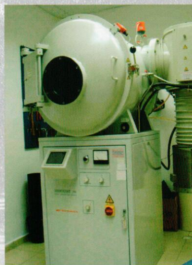
圖四 以色列國家警察總部指紋採驗組所有之BOC Edwards ID-750型真空金屬鍍膜設備
