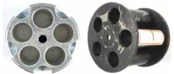
圖十、單一金屬塊切割、鑽孔製成(左)及金屬圓管和框架組合而成(右)之土造轉輪。
