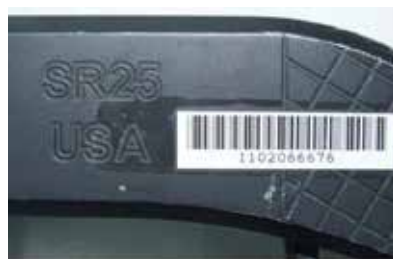
圖二十、後膛槍型非制式長槍表面的仿造槍枝型號和仿造製造國標示，無法用於辨識槍枝製造廠和製造國。
