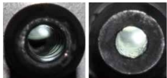
圖二十三、 針對具備來復線的單一彈丸後膛槍型非制式長槍，應辨識或量測其來復線的特徵。
