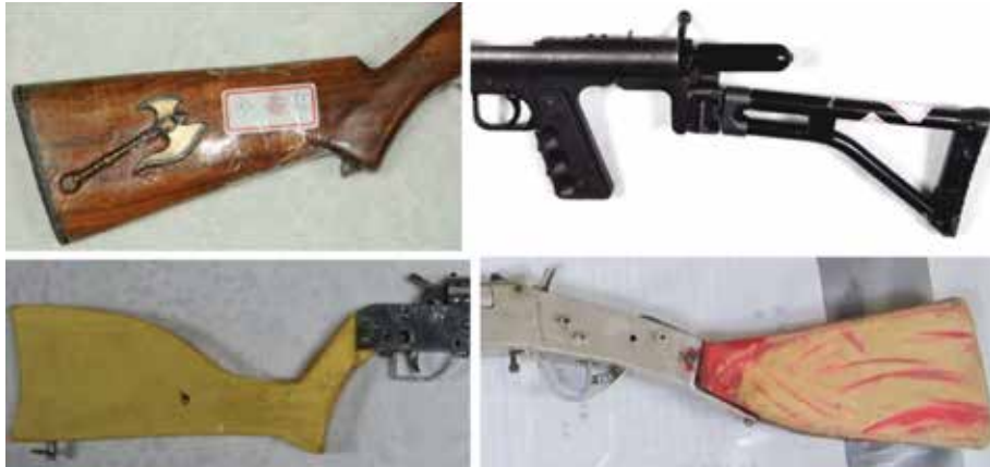
圖二十五、非制式長槍之槍托結構、形狀和材質的變異極大，為重要辨識特徵。
