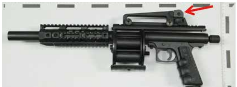
圖十四、裝有戰術滑軌、瞄準具及提把(箭頭指處)之轉輪式非制式長槍。
