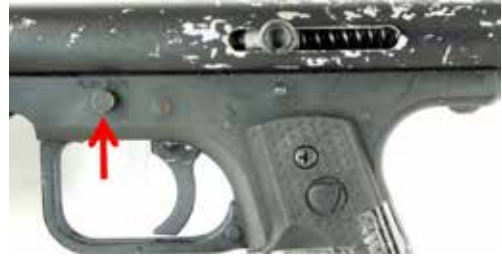
圖二十一、 使用原廠下機匣組合之非制式長槍保有其原始保險機構（箭頭指處）。
