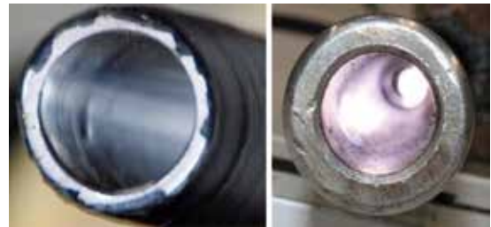
圖二十二、 後膛槍型非制式長槍具備無來復線槍管之例，左為散彈槍的槍管，右為單一彈丸槍枝的槍管。
