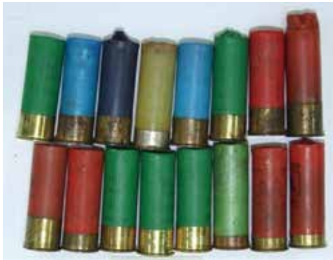
圖七、12 GA口徑散彈的塑膠彈殼顏色和金屬彈殼長度常因廠牌型號而異。
