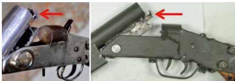
圖二十四、折開式非制式散彈槍開門狀態之擊發裝置機械構造，箭頭指處為退殼器。
