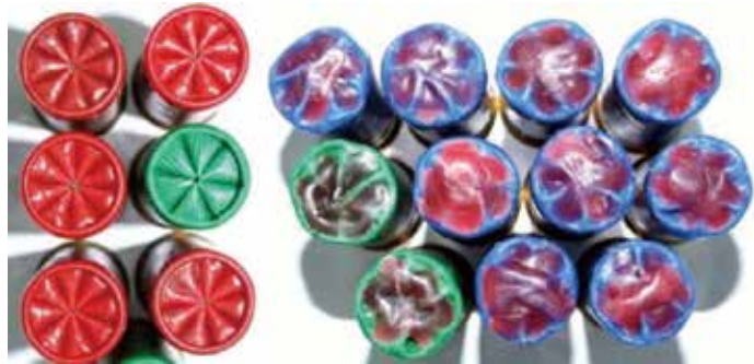
圖八、原廠散彈(左)和重新裝填散彈(右)的彈殼口部褶縮對稱性和密合度有明顯差異。
