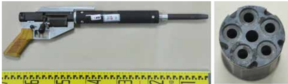
圖九、射擊單一彈頭定裝彈之轉輪式非制式長槍(左)及其轉輪容彈具(右)。
