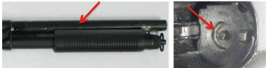
圖十六、手動幫浦散彈軟氣槍換裝土造鋼鐵槍管（左）並磨除撞針周圍突起（右），改造成手動幫浦式非制式長槍。
