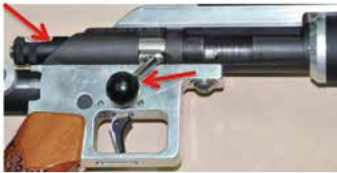
圖一、閂動式非制式長槍的長閂型槍機（左箭頭）和槍機拉柄（右箭頭）
