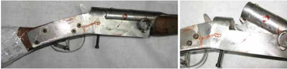
圖六、射擊標準口徑散彈的折開式非制式長槍閉鎖（左）及開門狀態（右）。
