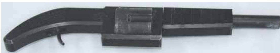
圖十七、不具槍托及現代手槍握把的後膛槍型非制式轉輪長槍。
