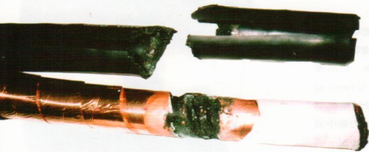
圖 5. 防蝕層電蝕引起之崩潰 與 環狀電蝕路徑
