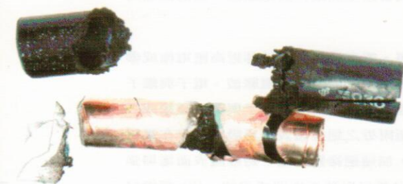
圖 5. 防蝕層電蝕引起之崩潰 與 環狀電蝕路徑
