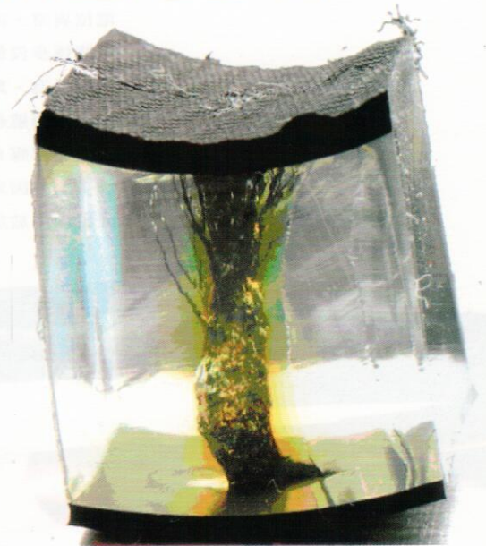
圖 3. 近外導電層引起之崩潰與電樹路徑
