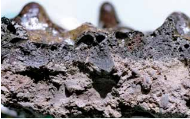
圖2、混凝土受燒後之型態與顏色特徵，黑褐色區域顯示表面受燒大於1200°C，草黃色區域顯示內部受燒大於900°C (3)
