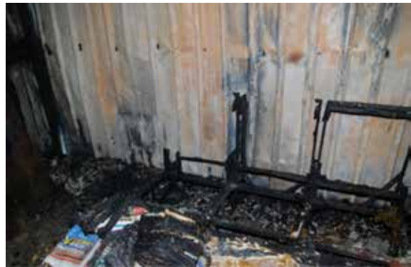
圖3、沙發受燒後造成材料質量損失兩側差異
