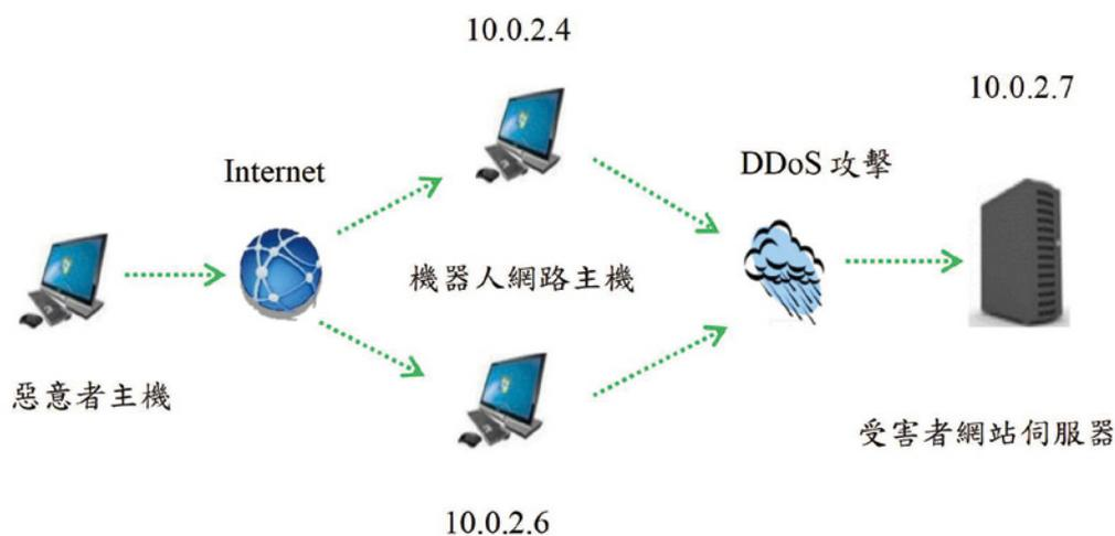
圖七、實驗網路架構示意圖（攻擊目標為10.0.2.7）
