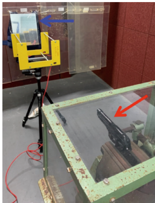
圖二、監測鋁板（藍箭頭）輔助非制式手槍（紅箭頭）殺傷力鑑定之裝置圖。
