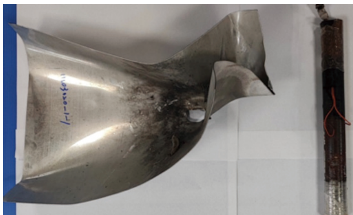
圖五、鋼管爆裂物試爆結果造成監測鋁板貫穿並嚴重變形。
