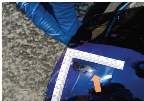
圖3、面罩藍色轉移漆及撞擊凹陷痕
