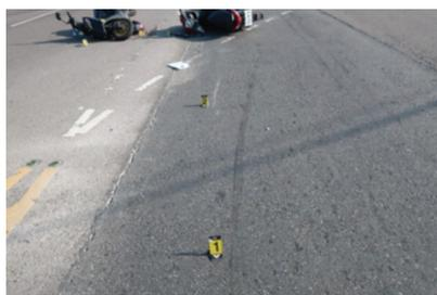
圖8、煞車痕、刮地痕
