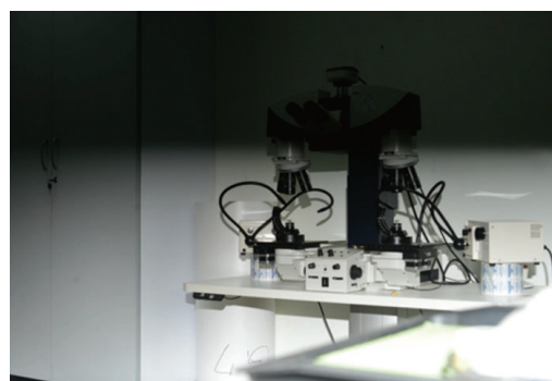
圖二十二、快門速度大於X同步速度時，閃光燈無法均勻打到整個畫面（F=5.6、1/500秒、ISO=250）
