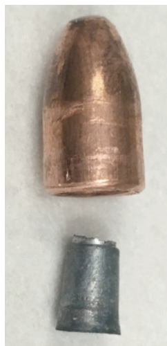
圖5、PC7彈頭之包衣和內核外觀及X射線能譜圖
