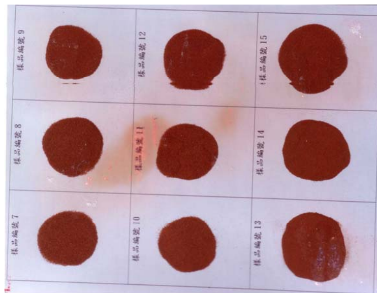
圖 2 各土壤樣品於 850°C 灰化後之顏色
