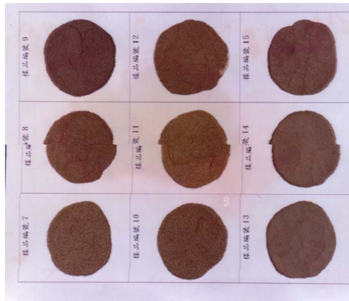
圖 1 各土壤樣品 100°C 烘乾後的土壤顏色
